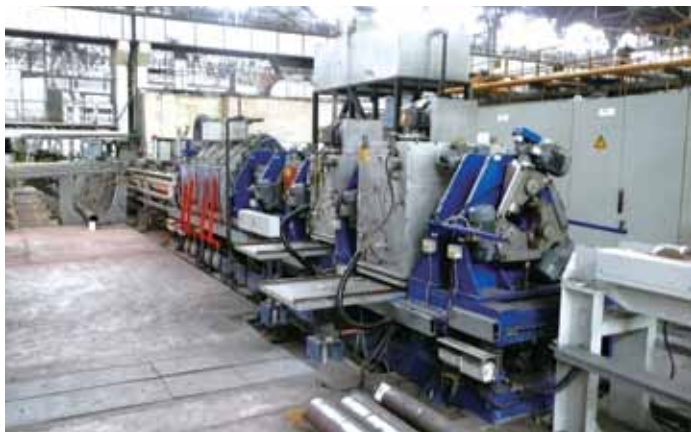
MAC的用于OCTG（石油专用管材）检测的超声波和漏磁联合检测系统
