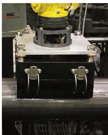
弹簧加载的探头模块和探靴正在对焊管进行检测
