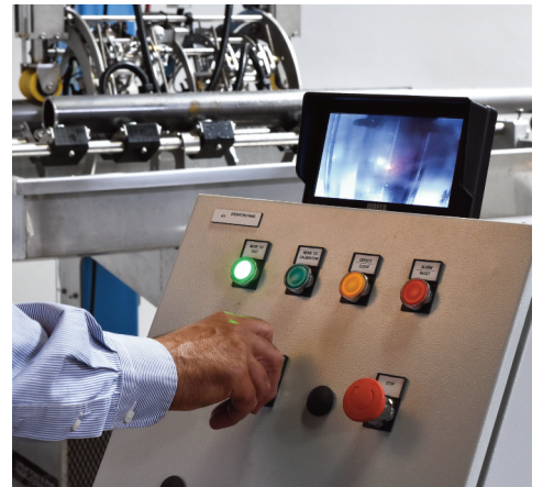
远程操作站包含基本的控制，如用于核验探头相对于焊缝区域位置的视频监控器，以及进行调节的“操纵杆”
