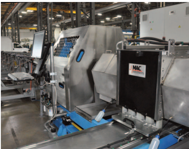
图为 Echomac® FD6 II 仪器以及 Echomac® UT 100 mm 旋转体，用于检测冷加工碳钢、合金和不锈钢棒材。
