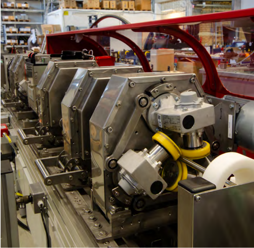
三轮夹持系统特写，该系统可以根据检测产品的高度和直径进行调节
