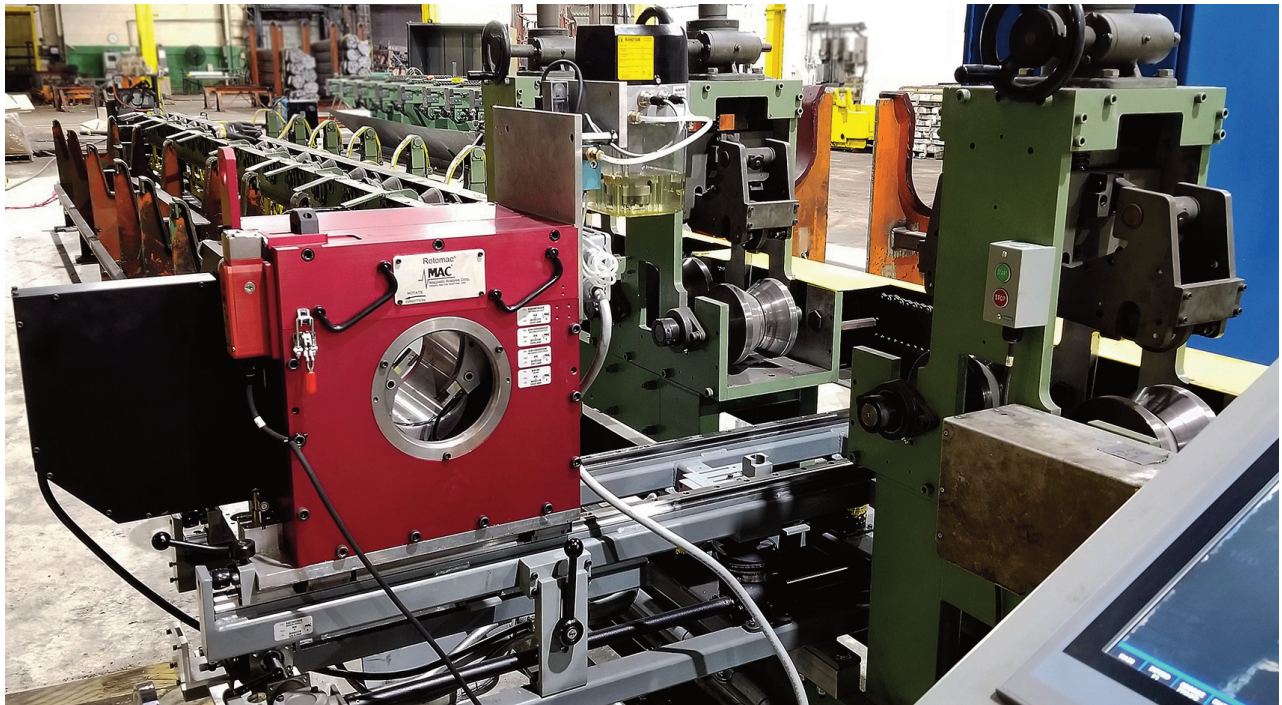
一套 Rotomac® 150mm 旋转头安装在美国一家工厂用于检测冷轧棒材
